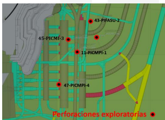
Figura 1.20. Localización en planta de perforaciones en el complejo de casa de máquinas (Fuente: Equipo técnico UNAL, 2018).
